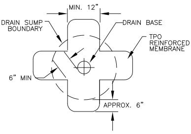
CUT SECTION OF TPO REINFORCED MEMBRANE AS SHOWN AND POSITION INTO DRAIN SUMP. EXTEND MEMBRANE OUT OF DRAIN SUMP APPROXIMATELY 6" (ROUND CORNERS).
