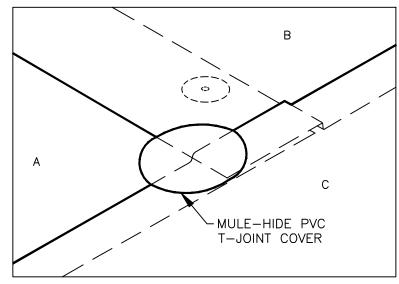
INSTALL A MULE—HIDE PVC T—JOINT COVER CENTERED OVER SPLICE INTERSECTION ("T—JOINT") AS SHOWN.
