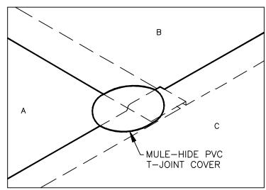
INSTALL A MULE-HIDE T-JOINT COVER CENTERED OVER SPLICE INTERSECTION ("T-JOINT") AS SHOWN.
